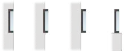
ZAPUŠTĚNÉ ČÁSTEČNĚ ZAPUŠTĚNÉ DO ZDI VOLNĚ STOJÍCÍ
